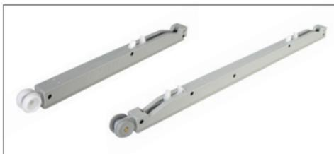
Der PTO arbeitet mit einer Druckfeder und wird in das hintere Ende der Laufschiene montiert. Mit ihm lassen sich Schiebetüren, die bündig in die Wand einfahren, mit einem kleinen Schubs auf das Türblatt komfortabel aus der Box holen. Ein Stirnziehgriff wird nicht mehr benötigt.
