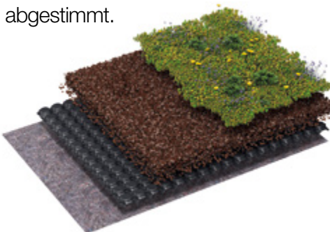
Die Dachbegrünung verbessert den Hitzeschutz im Sommer und spart Heizenergie im Winter. Du kannst z. B. wählen zwischen dem Classic Extensivgründach und dem BMI Leicht-Gründach.
