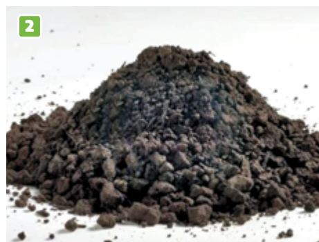
EXTENSIVSUBSTRAT E Dient als Vegetationstragschicht für Extensivbegrünungen
